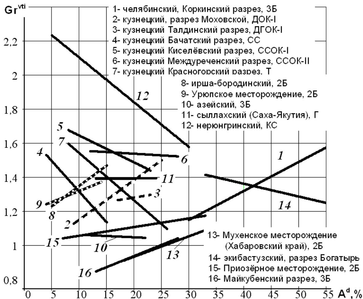
Рис. 10. Изменение коэффициента размолоспособности по данным [2] в зависимости от зольности для некоторых выбранных для иллюстрации углей
